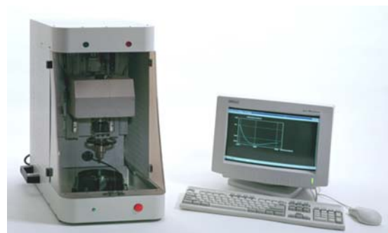
Fig. 3. CETR UMT-2 tribometer
