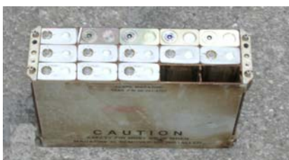
Fig. 11 Lansatoare cu 15 locașuri rectangulare 1" x 2" x 8"
