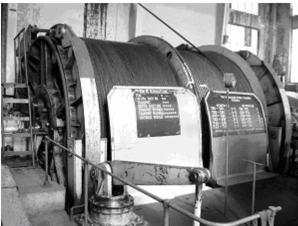
Fig. 5. Mașină de extracție tip 2T 3,5 x 1,7 „ Puț auxiliar nr.2 “ E.M. Bărbăteni
