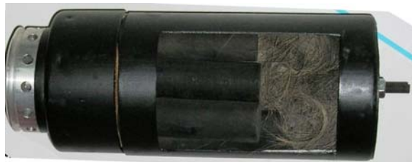
Fig. 17 Grenada reactivă cal.81mm pentru bruijaj mixt RL+ fumigen AL
