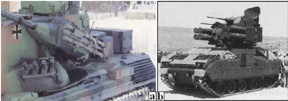
Fig.6: Sistem mixt Gepard-Stinger (a) și ADATS-tun 25 mm (b)
