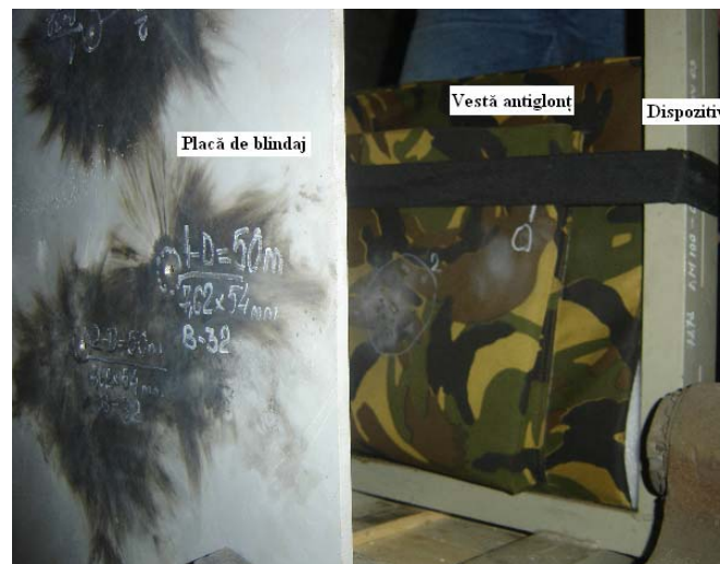
Fig. 2 : Impactul dintre gloanțe perforant – incendiare calibru 7,62 x 54 mm și configurația formată din placă de blindaj 6 mm și vestă antiglonț
