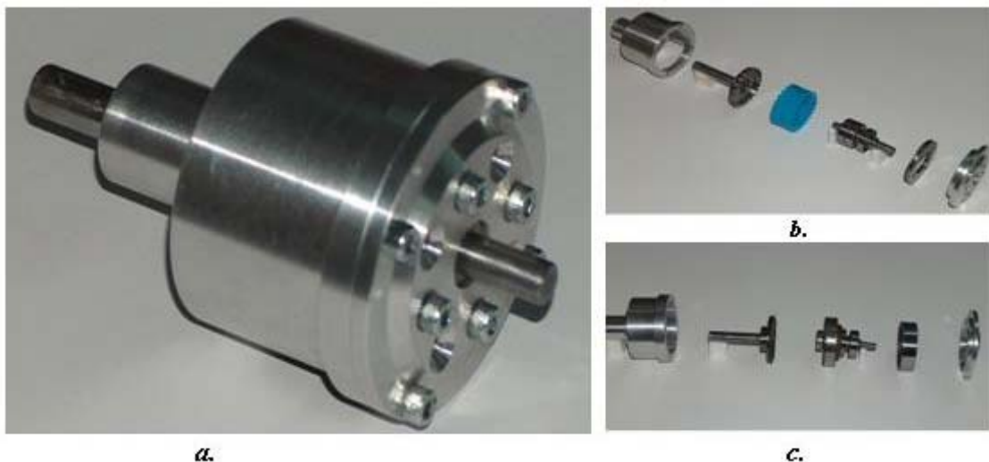
Fig. 6. Reductor precesional cinematic (a) cu bloc satelit din masă plastică (b) și din pulberi metalici (c).
