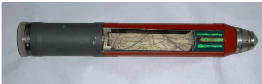
Fig. 14. Proiectilul reactiv cal. 82mm cu capcană aerosoli AL
