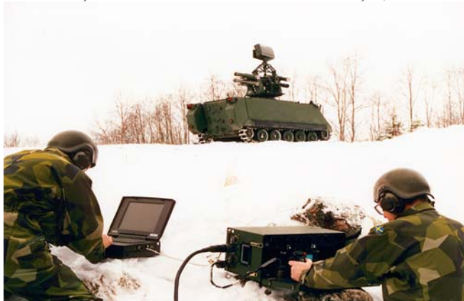
Fig.5: Modalitate de comandă a armamentului dintr-un adăpost, folosită la sistemul ASRAD-R , prin intermediul unui cablu de legătură
