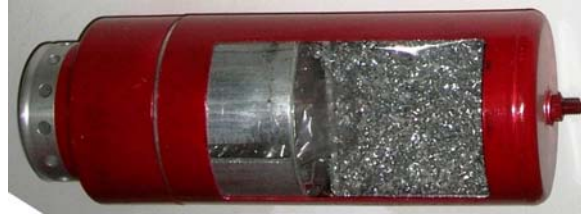
Fig. 16 Grenada reactivă cal.81mm pentru bruijaj mixt RL + IR
