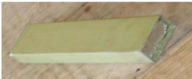
Fig. 9 Muniția 1" x 2" x 8" cu capcană termică – IR
