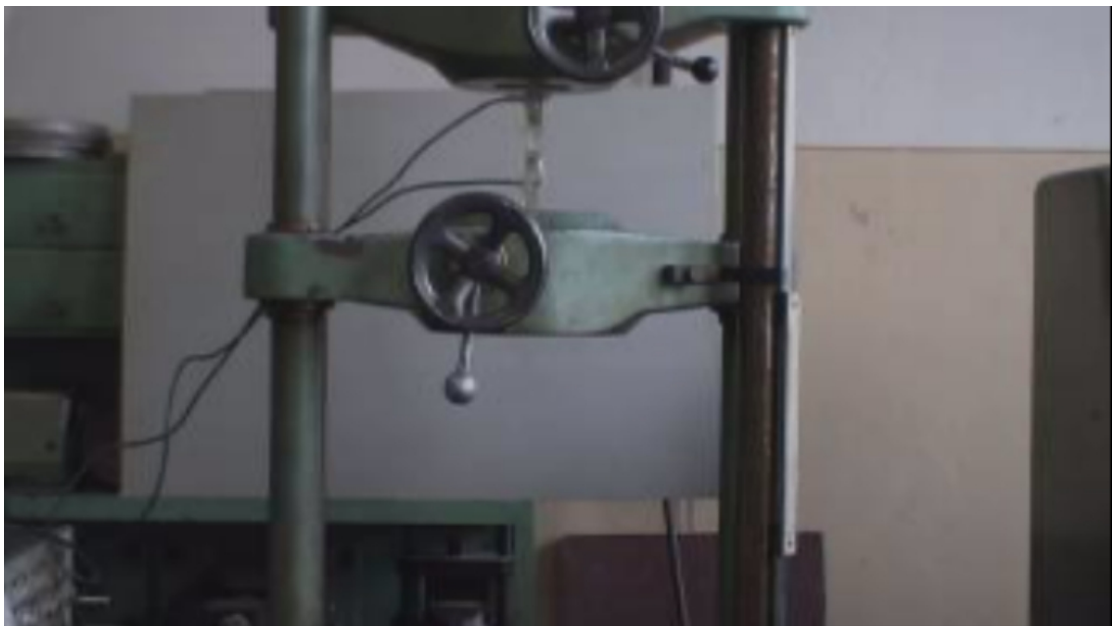
Fig. 5 Epruvetă în mașina de încercat universală ZD-20
