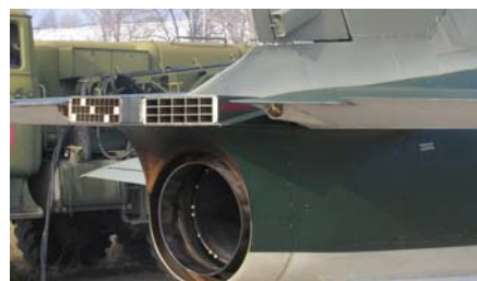
Fig. 11 Lansatoare cu 15 locașuri rectangulare 1" x 2" x 8"
