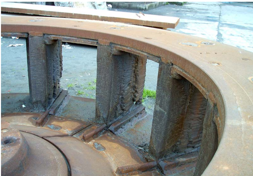
Fig. 1 – Rotorul morii MV 50, după 1200 ore de funcționare a paleților de măcinare
