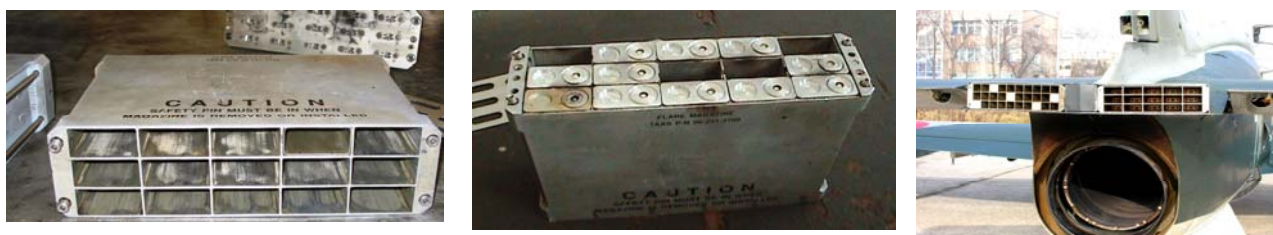
Fig. 10 Lansatoare cu 15 locașuri rectangulare 1" x 2" x 8"
