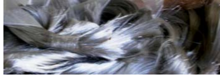
Fig.2 - Fire din sticlă metalizată pentru execuția dipolilor
