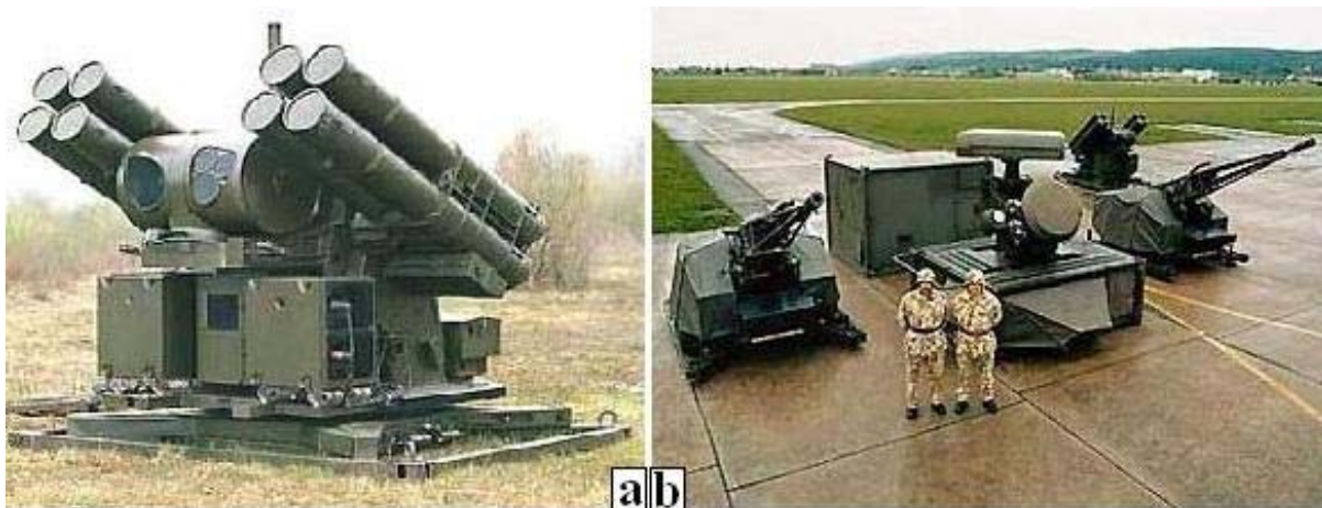
Fig.2: Platformă ADATS (a) de lansare rachete și integrarea acesteia (b), prin intermediul unității de comandă a focului ( FCU ), în cadrul sistemului de tunuri antiaeriene Skyshield
