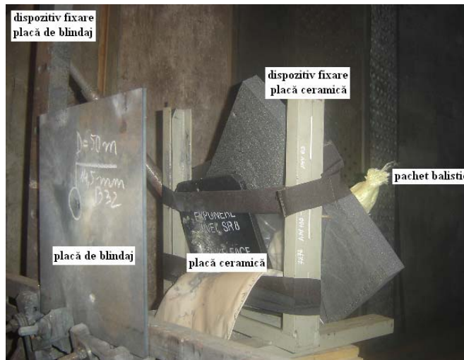
Fig. 4 : Impactul dintre gloanțe perforant – incendiare calibru 14,5 x 114 mm și configurația formată din placă de blindaj 6 mm și vestă antiglonț
