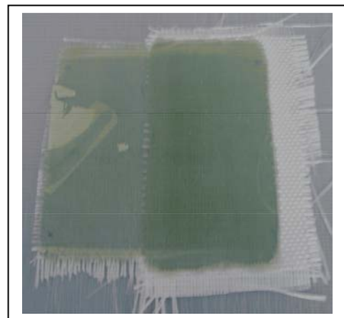
Fig. 1.2 : Placă cu 3 straturi (stânga) și 7 straturi (dreapta)
