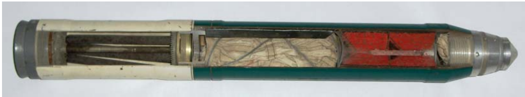
Fig. 13 Proiectilul reactive cal. 82 cu capcană IR
