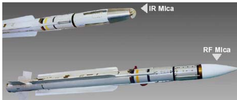
Fig.7: Coordonatoare IR și RF –caracteristice rachetelor lansate de sistemul VL-MICA
